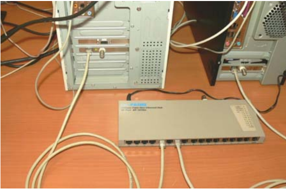
Мал. 2.5. З'єднання комп'ютерів з комунікаційним пристроєм за дротовою технологією
