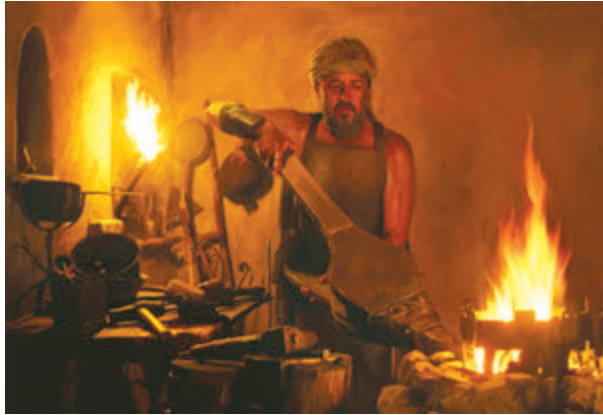
Мал. 106. Міхи для нагнітання повітря в полум'я для підвищення його температури
