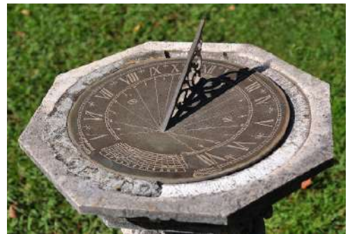
Мал. 29.1. Сонячний годинник. Тінь від стрілки вказує час
