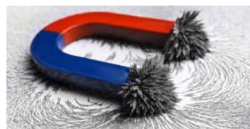
Мал. 23.2. Силові лінії магнітного поля навколо магніту (а) можна виявити залізним порошком (б)
