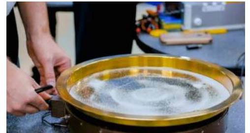
Мал. 42.4. Металевий таз із білим піском поставлено на джерело звуку (динамік). Звукові коливання від динаміка передаються піску, і ми «бачимо» звук
