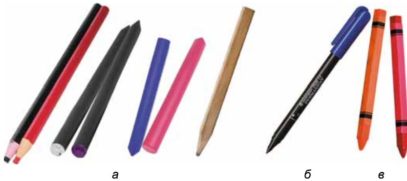
Мал. 37. Інструмент для нанесення міток: а – спеціальні олівці; б – маркер; в – воскова крейда
