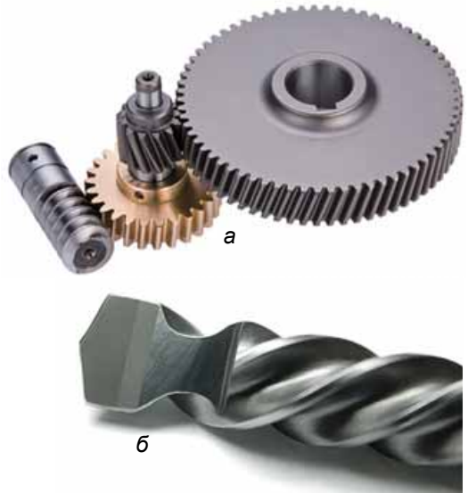
Мал. 4. Вироби, виготовленi методом порошкової металургiї: а – мiцнi високоточнi деталi; б – високомiцне свердло
